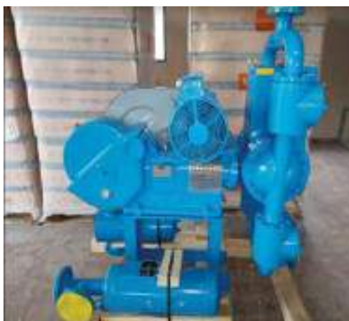
Bomba de elevação de Lamas para o Filtro Prensa
