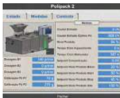
Sistema automático de preparação e doseamento de polieletrólito
