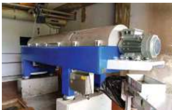
Centrífuga para desidratação de Lamas
